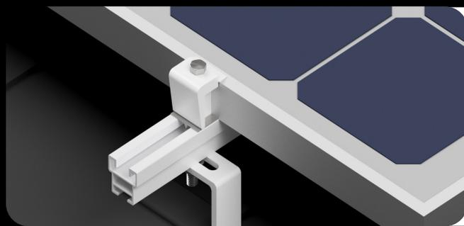
Colocar o módulo e inserir o grampo terminal no perfil. Certificar-se de que todos os contatos sejam feitos. Fixar os parafusos dos grampos com torque de 10N.m.
