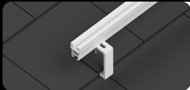
Fixar o perfil no suporte utilizando o parafuso cabeça-martelo e porca. Pode-se instalar o suporte até 0,5m da extremidade do perfil.
