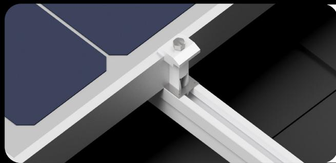
Inserir o grampo intermediário no perfil e certificar-se de que todos os contatos sejam feitos. A chapa de aterramento deve estar alocada entre o módulo e o perfil. Fixar os parafusos dos grampos com torque de 10N.m.
