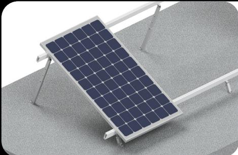
Assentar os módulos fotovoltaicos sobre os perfis e com o auxílio de um nível, verificar a angulação desejada. Obs: pequenos ajustes podem ser feitos no suporte angular.
